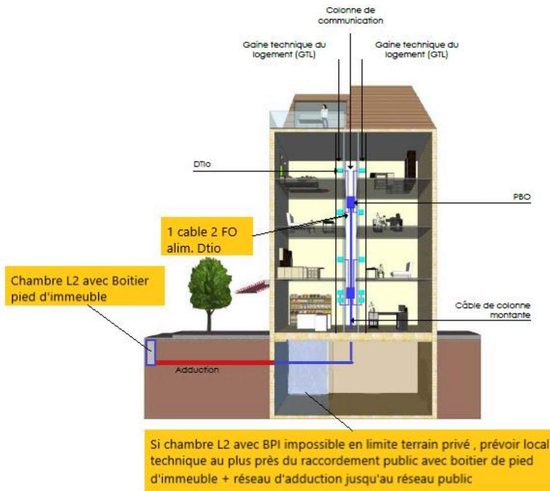
Lors de la création des logements, le promoteur /constructeur doit poser la prise optique (DTIo) dans le tableau de communication, installer un fourreau et un câble optique 2FO (bi-fibre) de raccordement jusqu'au PBO dans la colonne
